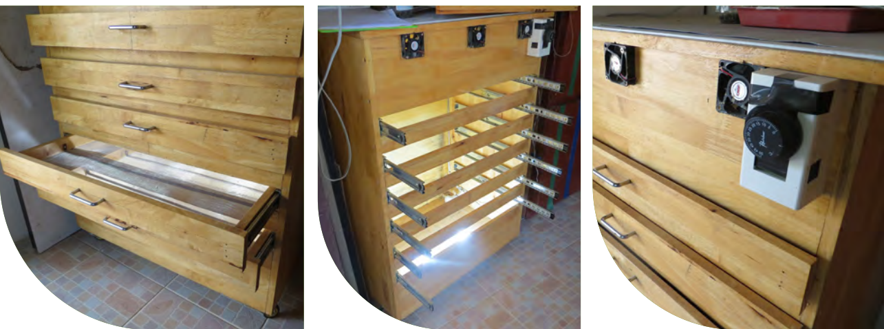
Secador de gabinete para semillas con cajones (izquierda), herrajes para estantes de malla extraíbles (centro), bombillas como la fuente de calor (centro), termostato para control de temperatura (derecha) y ventiladores CD de computadora para hacer circular el aire (derecha).
