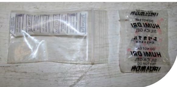
Paquetes de gel de sílice con (izquierda) y sin (derecha) cristales indicadores
