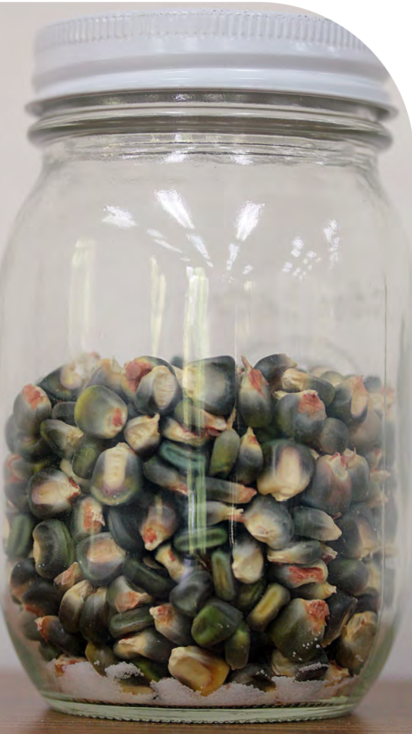
Frascos con sal y submuestras de semilla de maíz; la sal al fondo del frasco indica semilla seca.
