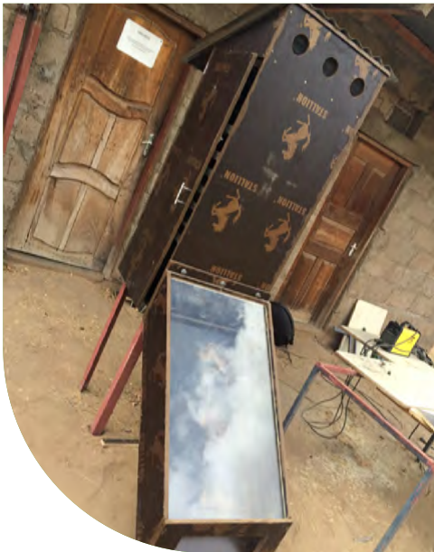
Secador solar de chimenea para secar biomasa vegetal o semillas.
