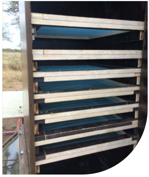
Secador solar de chimenea para secar biomasa vegetal o semillas.
