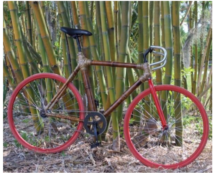
Figura 2. Una bicicleta fabricada con bambú! Fuente: Craig Bielema, quien construyó la bicicleta a partir de un matorral de bambú que se encuentra al fondo en la foto.
