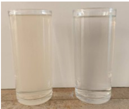
Figura 8. Antes (izquierda) y después (derecha) de filtrado en demostración en sitio de ECHO Asia. Fuente: Personal ECHO Asia
