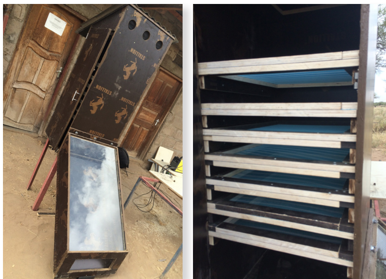
Figura 4. Secador solar utilizado en ECHO en Tanzania. La luz solar calienta la superficie de plástico de la caja de calentamiento (abajo a la izquierda). Después el calor sube a la cámara de secado de bastidores de rejilla (derecha). De esta manera, la biomasa de la hoja no se expone a la luz ultravioleta. Fuente: Stacy Swartz
