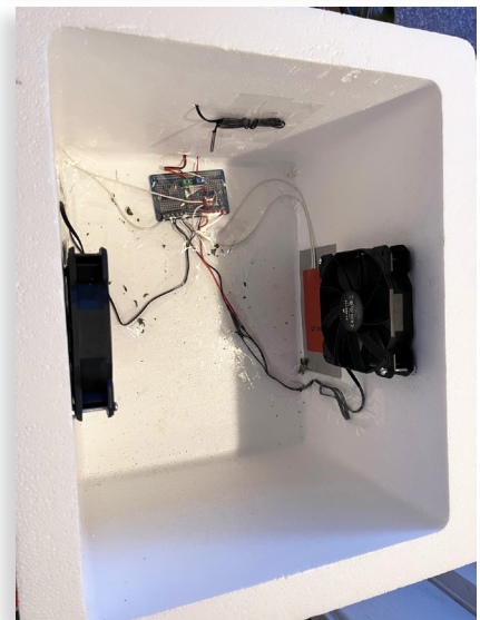
Figura 5. Un secador de moringa de temperatura controlada hecho con un enfriador de espuma de poliestireno (arriba), equipado en el interior (abajo) con ventiladores de computadora de 12 voltios y mini almohadillas térmicas.
