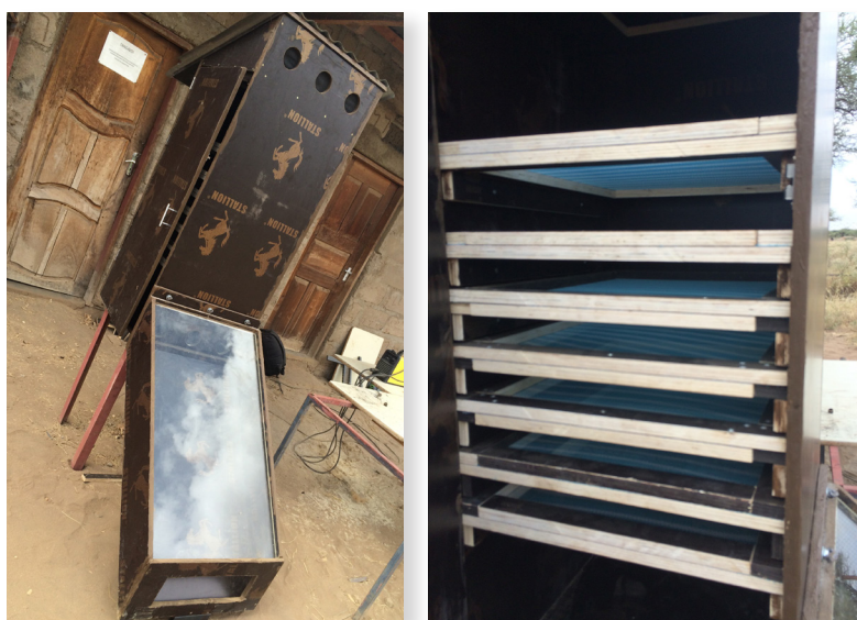
Figure 4. Séchoir solaire utilisé par ECHO en Tanzanie. La lumière du soleil chauffe la surface en plastique de la boîte chauffante (en bas à gauche). La chaleur monte ensuite dans la chambre de séchage équipée de grilles (à droite). De cette manière, la biomasse des feuilles n'est pas exposée à la lumière ultraviolette.
