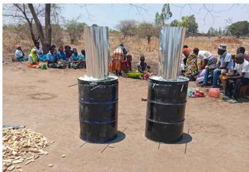
Figura 4. Capacitación sobre biocarbón impartida por Warm Heart en Malawi con hornos de tiro ascendente de encendido en la parte superior.
