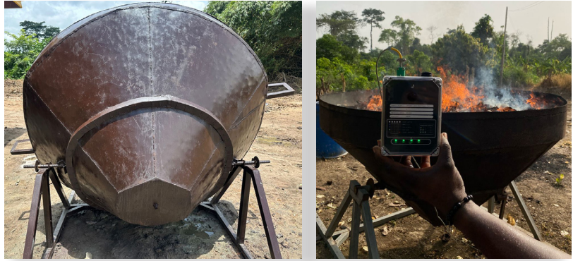
Figura 2. Un horno Kon-Tiki (izquierda) y un proceso dMRV en Ghana (derecha). La imagen de la derecha muestra el dispositivo Greenbox de Planboo , un sensor térmico IoT instalado en cada horno para monitorear el proceso de pirólisis. Fuente: Samuel Gyasi
