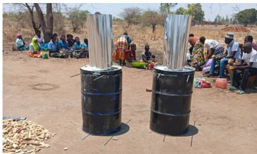
Figure 4. Formation de Warm Heart sur le biochar avec des fours à pyrolyse à courant ascendant (Top Lit Updraft) au Malawi. Source: Warm Heart Worldwide
