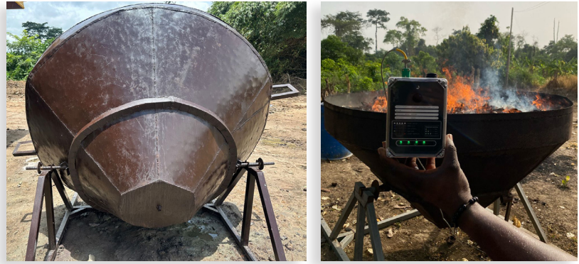
Figure 2. Un four Kon-Tiki (à gauche) et le processus de mesure, notification et vérification numérique (MNV) au Ghana (à droite). L'image de droite montre le dispositif Greenbox de Planboo, un capteur IoT thermique installé sur chaque four pour surveiller le processus de pyrolyse. Source: Samuel Gyasi
